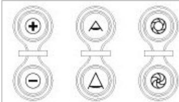
**ZOOM In/Out:** utilizzati per ingrandire / ridurre la visione delle immagini regolando l'ottica.
