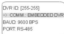
③ **Programmazione Baud Rate:** analogamente a quanto detto sopra è possibile, all'interno di un certo range di indirizzi DVR, assegnare un valore relativo alla velocità di trasmissione sulla linea dati (espressa in baud). Spostare il cursore verso l'alto o verso il basso sino a selezionare questa opzione e quindi ruotare il joystick in senso orario o antiorario.
