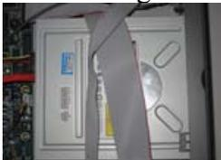
3. Posizionare il dispositivo nell'apposito alloggiamento in corrispondenza dell'apertura frontale e fissarlo tramite le viti.
