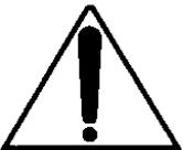
Il punto esclamativo all'interno di un triangolo equilatero sta ad indicare all'utente l'esistenza di un'istruzione riguardante una funzione o una modalità di manutenzione particolare descritte all'interno della documentazione che accompagna il prodotto.
