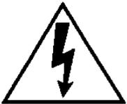
La folgore terminante con una freccia all'interno di un triangolo equilatero indica all'utente la presenza di tensioni non isolate pericolose all'interno del prodotto stesso che potrebbero rivelarsi di intensità sufficiente a provocare uno shock elettrico per le persone.
