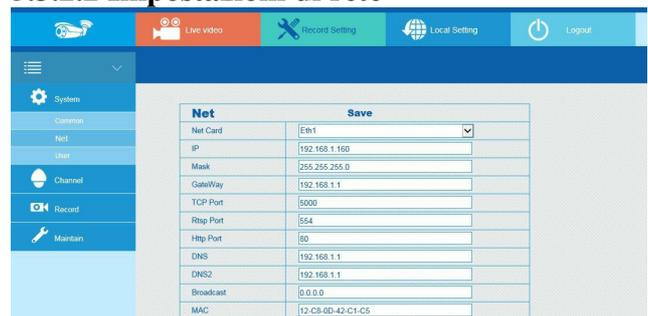
La finestra "Rete" consente di configurare i parametri di rete del sistema NVR: indirizzo IP, Gateway, porte e DNS. Si raccomanda di prestare attenzione nella modifica di questi parametri da remoto in quanto questo potrebbe portare alla perdita della connessione.
